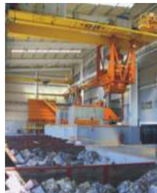
Preparação de carga metálica e aditivos
